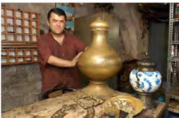
Pour que le cuivre ne se déforme pas lors du ciselage, l'artisan coule du goudron dans les pots.
